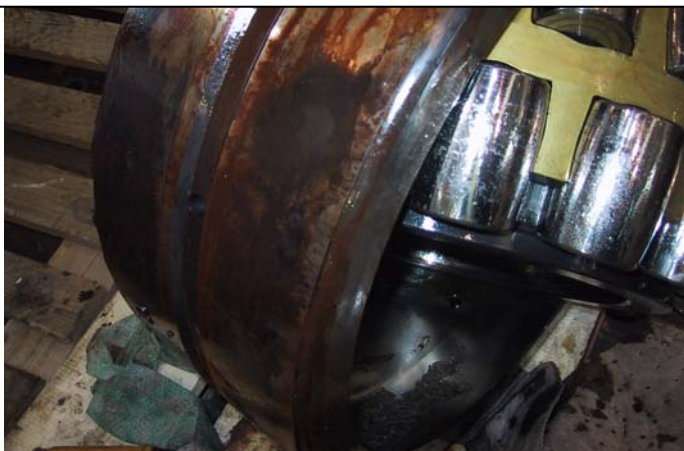
Lager med rustskader på ytterringen
