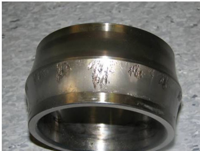
10 ledevalselager oppdaget, 3 arbeidsordre skrevet, 1 lager byttet (pr.17.09.2007)
